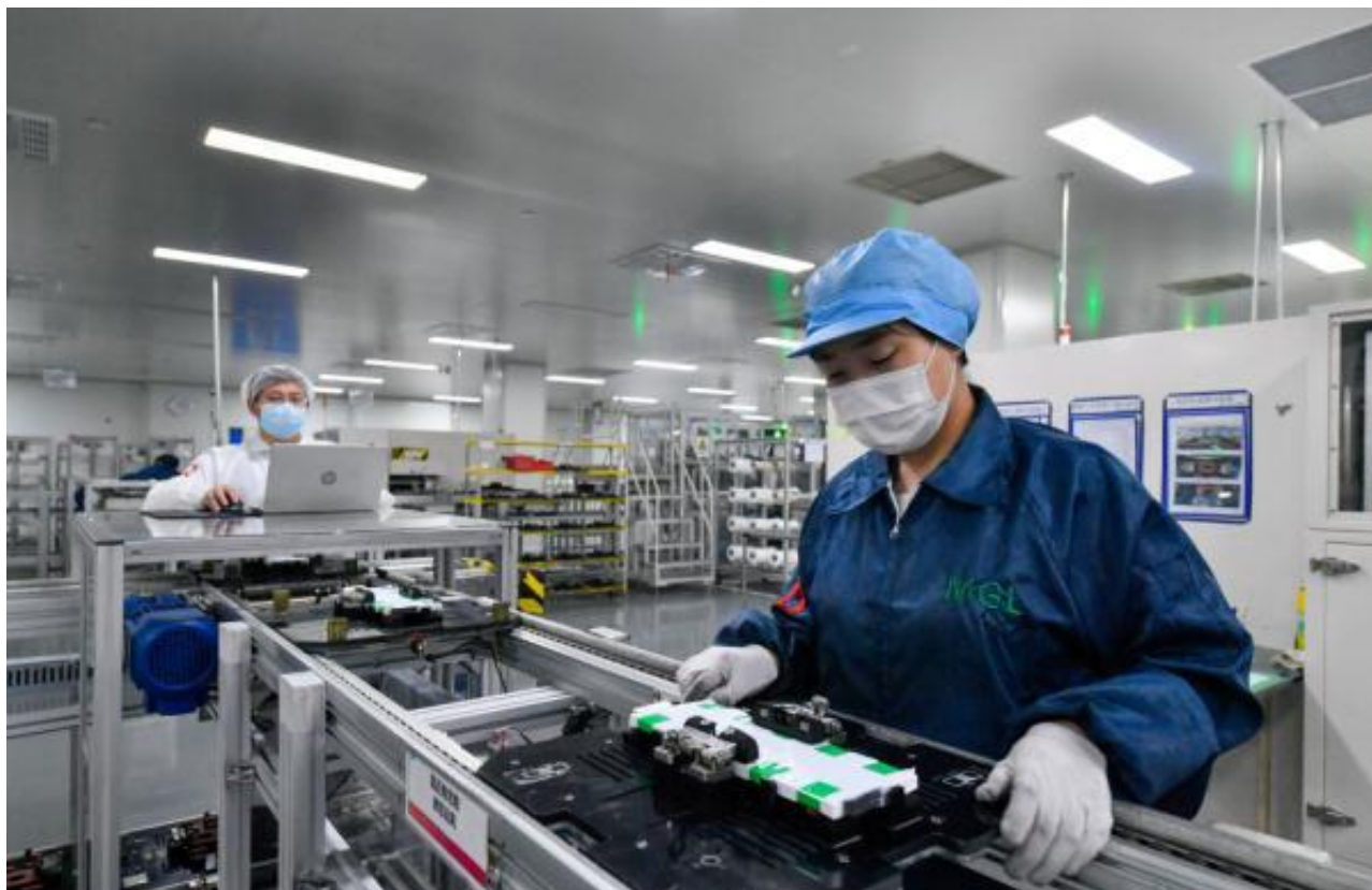
7月25日，在天津荣盛盟固利新能源科技有限公司装配车间，工作人员对生产出的动力电池电芯进行人工复检。
