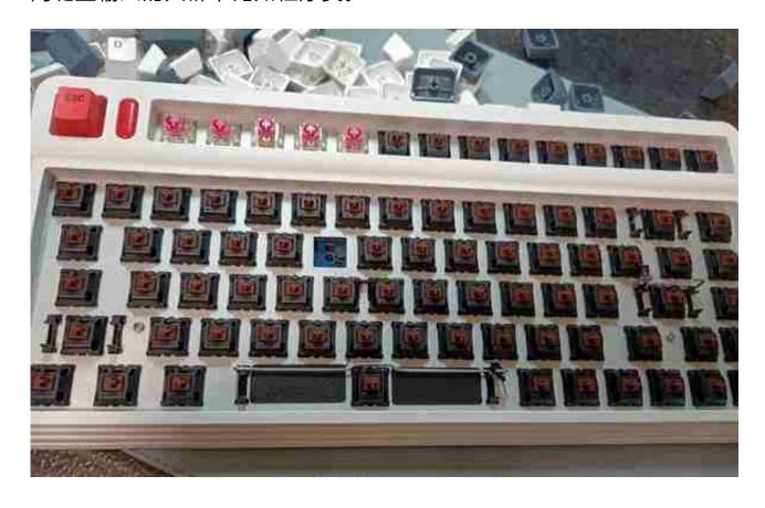
另一种下盖侧面露出的面积比较大,上盖只覆盖顶部和侧面一点点的部分,类似我们常规的糖果盒结构,它的敲击感受和声音和船壳会接近一些。
