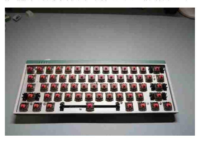
而像Cherry G80-3000系列、MX3.0S系列等,没有定位板,轴体直接通过2个金属针脚和三个固定柱插在PCB板上。以内PCB板比定位板要柔软很多,这类键盘触感反馈相对柔和,但也会有朋友觉得敲起来不够过瘾。
