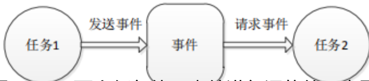
图 34.1.1 两个任务使用事件进行通信的示意图
